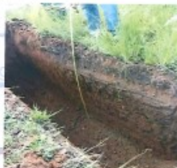
8. Lençol freático encontrado (1,70 m).
